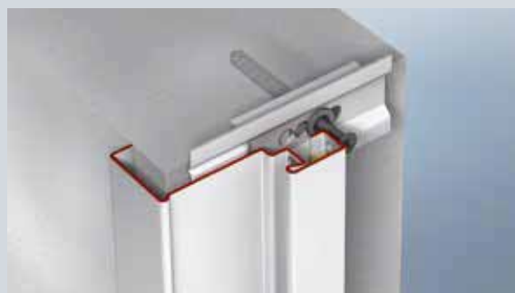
Vissage du profilé d'huisserie d'angle 1 dans l'ossature métallique
