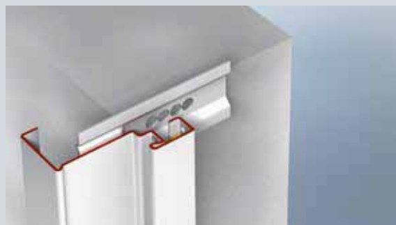
Positionnement puis alignement dans la baie du profilé d'huisserie d'angle 1
